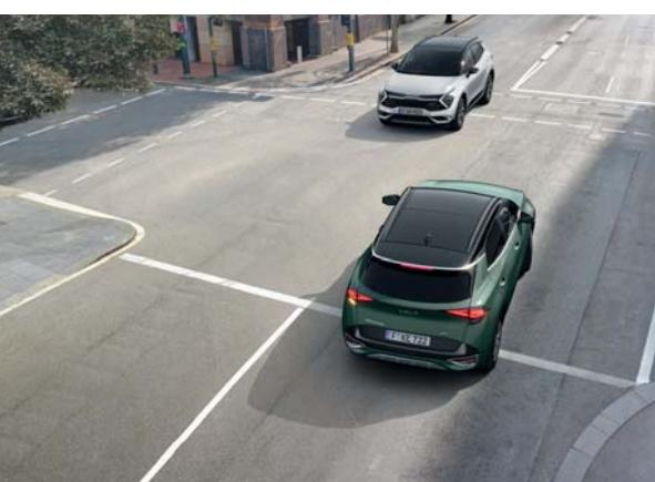
**Systém autonomního nouzového brzdění FCA (Forward Collision-Avoidance Assist).** Systém FCA detektuje vozidla, chodce nebo cyklisty před vozem na základě vyhodnocování dat z přední kamery a radarového senzoru, aby zabránil hrozící kolizi s nimi. FCA také předchází kolizím s vozidlami při odbočování vlevo na křižovatce. Jakmile systém detektuje hrozbu kolize, objeví se na panelu sdružených přístrojů výstražné upozornění a dojde k aktivaci maximálního brzdného výkonu.
