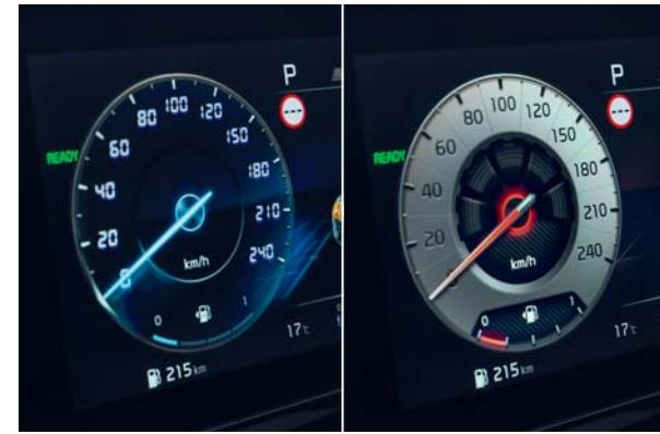
**12,3" panel sdružených přístrojů s širokoúhlým displejem.** Výbava zahrnuje nejmodernější displej TFT LCD s neuvěřitelně precizním a čistým grafickým zobrazováním. V závislosti na pohonu nabízí zcela nová Sportage řadu jízdních režimů sahajících od modů Eco až po Sport. Zvolený jízdní režim je zobrazen na panelu sdružených přístrojů.
