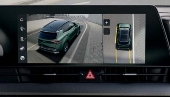
**360°monitorovací systém SVM (Surround View Monitor).** Soustava několika kamer Vám bude při manévrování ve stísněných prostorech poskytovat nastavitelný pohled shora na okolí vozidla v rozsahu 360°, abyste mohli řídit a parkovat s pocitem naprosté jistoty. Kvůli kontrole vzdálenosti od překážek nemusíte vystupovat z vozu, ani žádat ostatní o pomoc.
