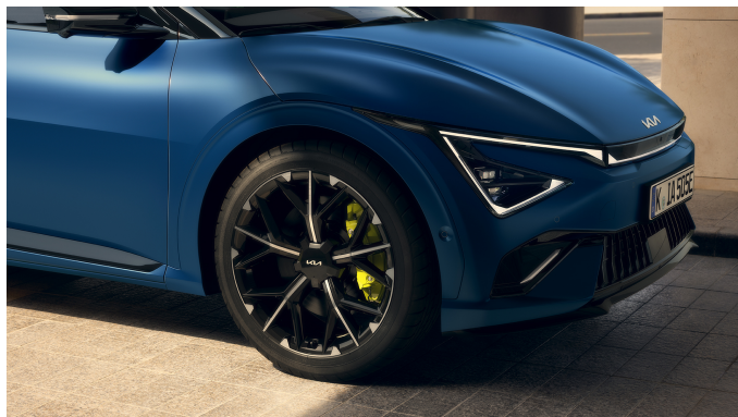
21" slitinový disk GT s pneumatikami 255/40 R21
