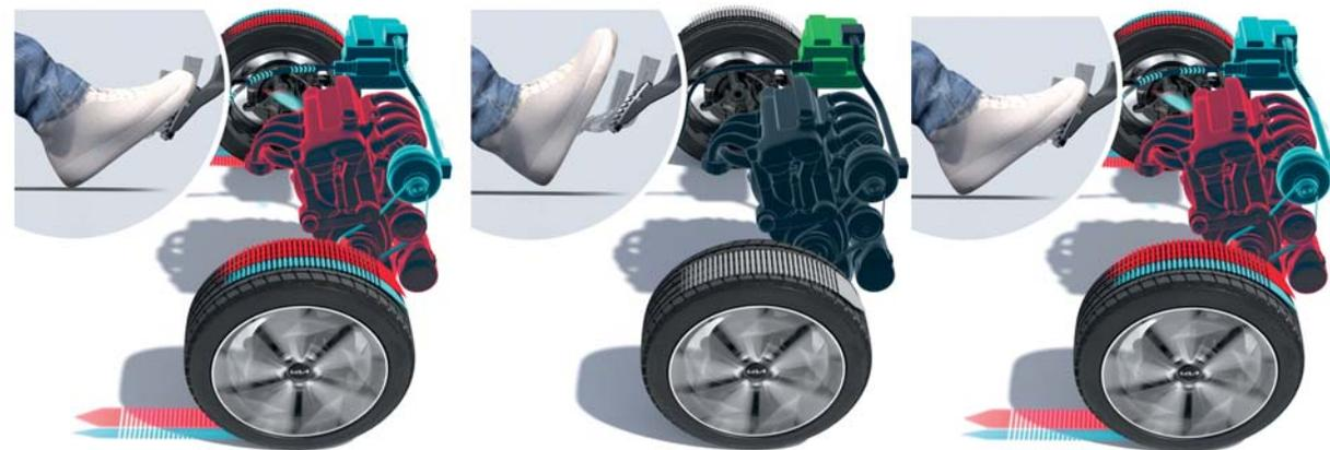
**Režim setrvačné jízdy.** Pokud řidič uvolní pedál plynu a nechá vůz jet setrvačností bez zrychlování nebo brzdění, motor se v závislosti na stavu nabití 48V akumulátoru vypne, čímž se zvýší hospodárnost jízdy. Jakmile sešlápně pedál plynu nebo brzdy, motor se okamžitě spustí. Funkce setrvačné jízdy a vzdálenost, kterou lze ujet s vypnutým motorem, závisí na provozních podmínkách a rychlosti jízdy.
