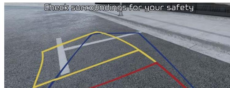
**Zadní kamera s vodicími liniemi.** Obraz ze zadní kamery můžete sledovat na 7" displeji na přístrojové desce, a to včetně dynamických vodicích linií, které ukazují trajektorii jízdy při manévrování.
