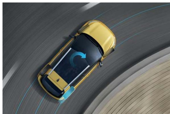
**Systém řízení brzdné síly v zatáčkách CBC.** CBC udržuje směrovou stabilitu při průjezdu zatáčkami asymetrickým brzděním jednotlivých kol, pokud řidič brzdí při změně směru jízdy. Tím předchází riziku ztráty trakce, což znamená vyšší úroveň bezpečnosti.
