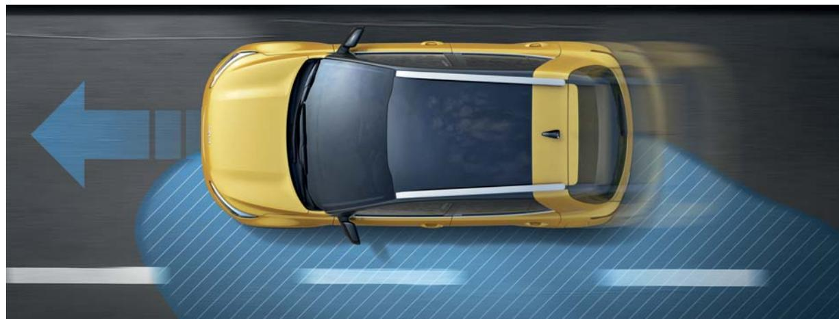
**Systém řízení stability vozidla VSM.** Systém VSM spolupracuje v modelu Kia Stonic s elektrickým posilovačem řízení, aby byla při současném brzdění a zatáčení zachována stabilita vozu.
