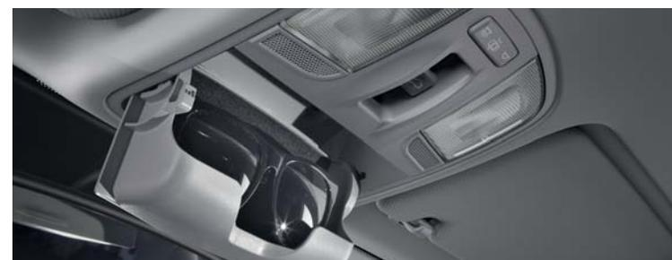
**Stropní konzola se svítilnami a schránkou pro sluneční brýle.** Stropní konzola přispěje k pořádku v interiéru. Do její schránky můžete uložit sluneční brýle, které snadno naleznete, aniž byste museli odvracet zrak od vozovky.
