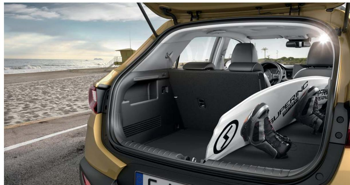
**Zadní sedadla dělená a sklopná v poměru 60:40.** Opěradla zadních sedadel jsou dělená v poměru 60:40 a jednotlivé části lze sklápat individuálně. Díky tomu máte různé možnosti, jak si uspořádat zavazadlový prostor a prostor pro cestující.
