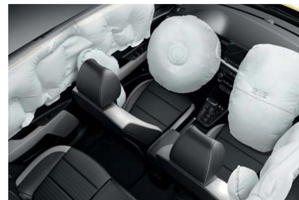
**6 airbagů.** Systém zádržných prvků pro ochranu cestujících zahrnuje čelní airbagy pro řidiče a spolujezdce vpředu, dva boční airbagy a dva hlavové airbagy v celé délce interiéru.
