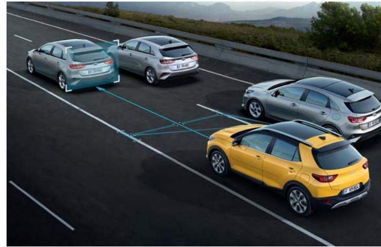
**Asistent následování v jízdním pruhu LFA.** Tento systém činí obrovský krok směrem k autonomnímu řízení. Systém LFA ovládá zrychlení, brzdění a řízení v závislosti na vpředu jedoucích vozidlech. Systém používá kameru a radarové senzory k zachování bezpečné vzdálenosti od vozidla vpředu a sleduje značení na vozovce, aby udržel Váš automobil uprostřed jízdního pruhu.
