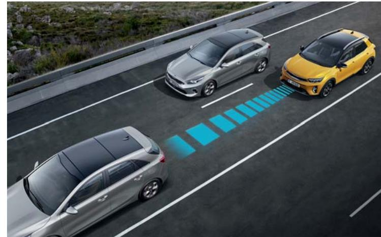
**Pokročilý adaptivní tempomat (SCC).** Pokročilý adaptivní tempomat používá integrovaný radarový senzor a dokáže měnit rychlost jízdy modelu Stonic i jeho vzdálenost od vozidla vpředu. Systém udržuje bezpečnou vzdálenost od vpředu jedoucího vozidla automatickým přizpůsobováním rychlosti jízdy. Pokud vozidlo vpředu zpomalí a není možné udržet nastavenou bezpečnou vzdálenost, sníží systém rychlost jízdy. Jakmile vozidlo vpředu zrychlí, vrátí se Stonic zpět k nastavené rychlosti jízdy.
