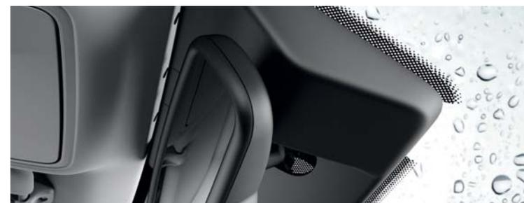
**Senzor deště.** Jakmile senzor deště zaznamená kapky na čelním okně, automaticky zapne stěrače.
