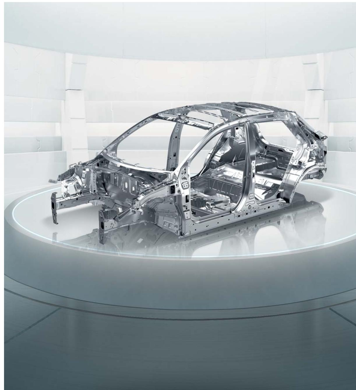
**Ocel AHSS zvyšuje odolnost interiéru a ochranu cestujících.** Stonic využívá vyspělé vysokopevnostní oceli AHSS (Advanced High Strength Steel), které všestranně zvyšují pevnost a tuhost karoserie. Fenomenální tuhost karoserie tak zvyšuje ochranu cestujících i úroveň dynamiky.
