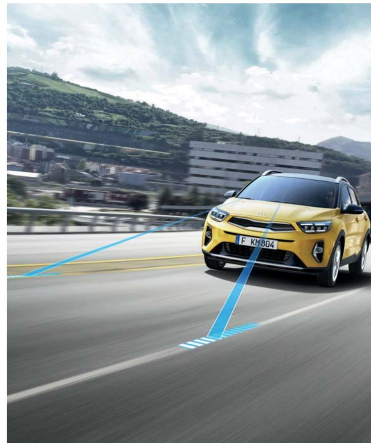
**Aktivní systém pro jízdu v pruzích (LKA).** Tento systém sleduje kamerou podélné značení na vozovce a kontroluje, zda se vůz nachází uprostřed jízdního pruhu. Upozorní Vás, že se vozidlo přibližuje k hranici jízdního pruhu, a v případě potřeby zasáhne do řízení, aby vůz nasměroval zpět.
