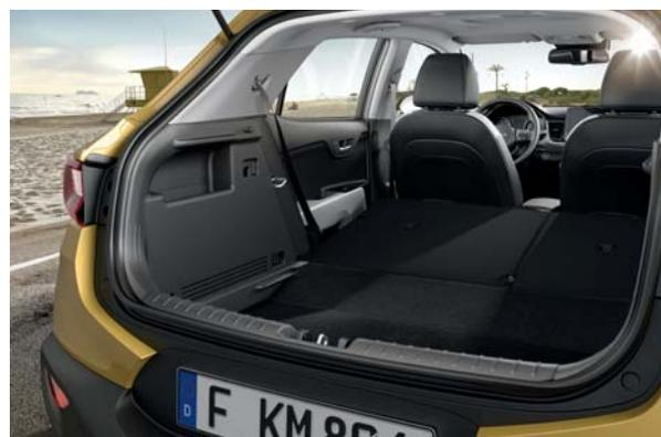
**Nastavitelná podlaha zavazadlového prostoru.** Po umístění do vyšší polohy vytvoří podlaha rovnou ložnou plochu se sklopenými opěradly zadních sedadel (vlevo). S podlahou v nižší poloze můžete do vozu naložit vyšší předměty (vpravo). (Podlaha zavazadlového prostoru ve verzích Mild Hybrid je umístěna vždy v nižší poloze)
