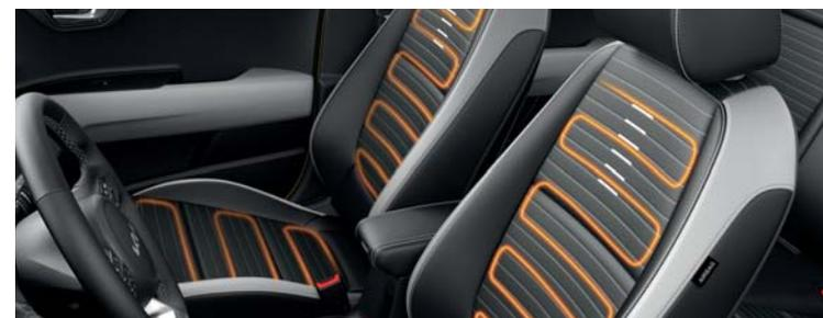
**Vyhřívaná sedadla vpředu.** Vyhřívání sedadel vpředu se třemi nastavitelnými intenzitami tepla rychle ohřeje sedáky a opěradla. Po dosažení požadované teploty se výkon sníží, aby byl zajištěn dokonalý komfort spolu s bezpečností.
